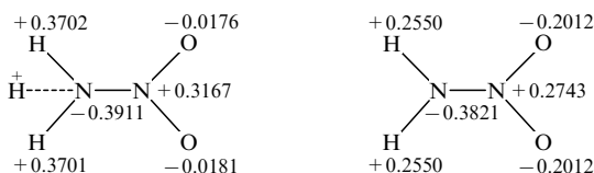
Рис. 3. Распределение зарядов на атомах протонированной (а) и непротонированной (b) форм нитрамида. 153
